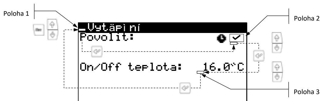
Obrázek 3.4. Příklad úpravy parametrů
