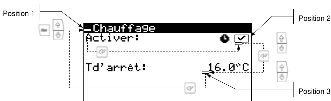
Figure 3.4. Réglage des paramètres de confort
